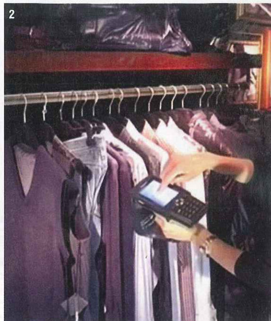
1 TRAMA: sistema per il tracciamento dei capi 2 di moda, a livello di collo e di item, nell'iter di gestione della distribuzione, dalla manifattura ai magazzini di stoccaggio, del magazzino e dell'inventario.
